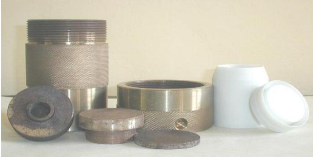
**Figure I-4** : Autoclave populaire utilisé pour le traitement hydrothermique
