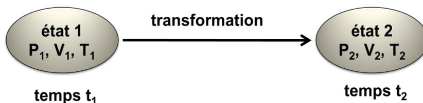
Figure I-2 : Transformation d'un système de l'état 1 à l'état 2.
