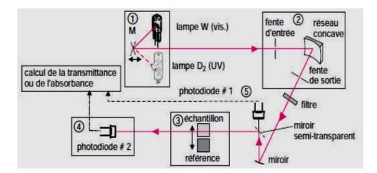
Fig.I.12 : Schéma d'un spectrophotomètre monofaisceau à monochromateur
