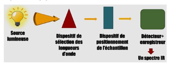
Fig.IV.19: Les éléments communs des spectromètres optiques
