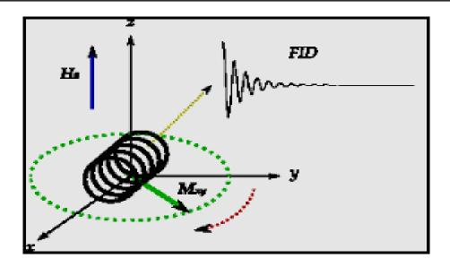
Fig.VI.4: Induction de la fem dans la bobine et signal de FID
