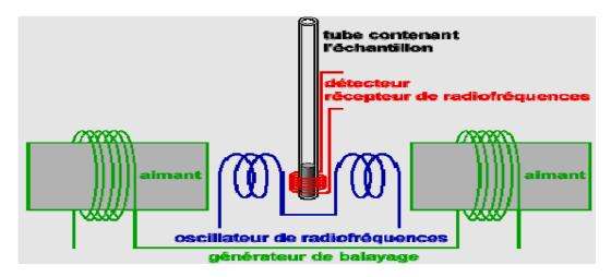
Fig.VI.18: Schéma d'un spectromètre RMN.
