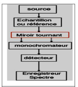
Fig.IV.21 : Spectromètre double faisceau.
