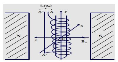
Fig.VI.5 : Dispositif expérimental permettant d'enregistrer le signal de résonance magnétique nucléaire (Spectromètre de RMN)
