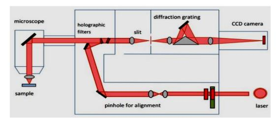
Fig.V.4: Présente le schéma d'un appareillage typique utilisé en spectroscopie Raman.
