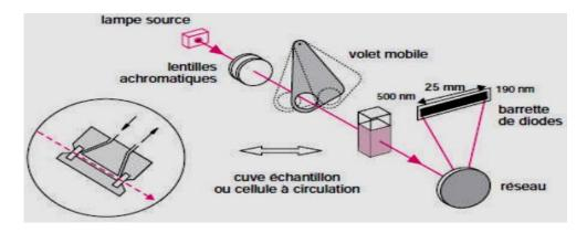
Fig.III.15 : Schéma optique d'un spectrophotomètre simple faisceau illustrant le mode simultané (spectromètre à barrette de diodes)
