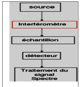
Fig.IV.22: Spectromètre simple faisceau à transformer fourrier.
