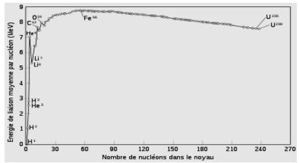
Fig.I.1: Courbe d'Aston: énergie de liaison par nucléon en fonction du nombre de masse, pour les isotopes les plus courants.
