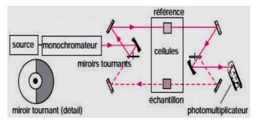
Fig.I.13: Schéma d'un spectrophotomètre à double faisceau
